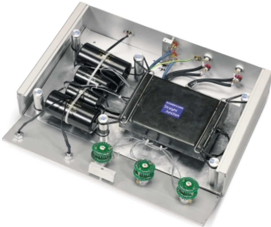
Die Hauptplatine ist vergossen und mit Kupferfolien und Blechen gegen elektromagnetische Einstrahlungen geschützt; das optionale Akkumetzteil tut ein Übriges
